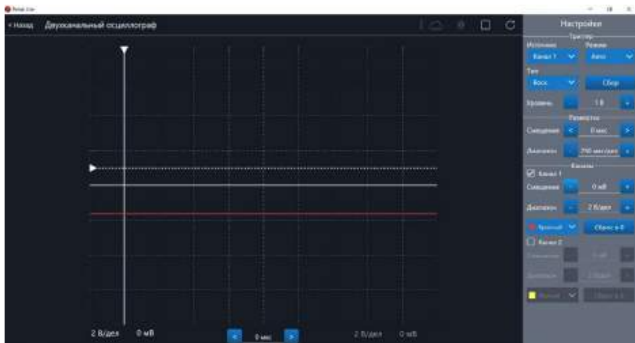
Рис. 40. Сигнал с ненулевым смещением
