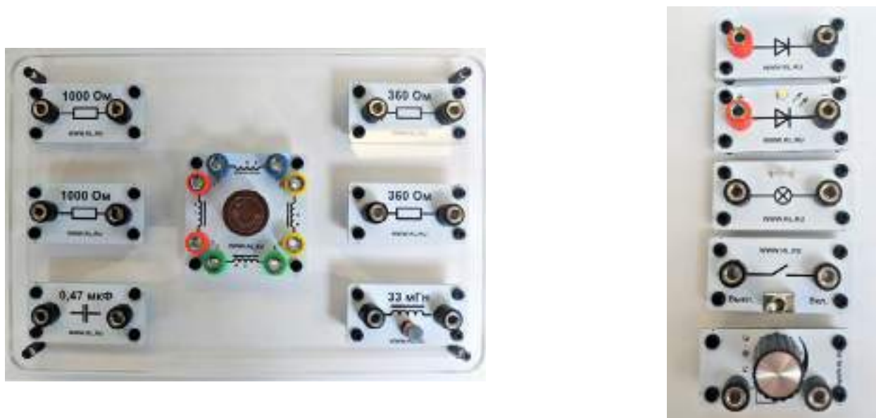
Рис. 17. Дополнительные элементы электрических цепей
